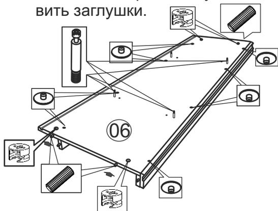
Крышку 05 оборудовать соединительными винтами.
