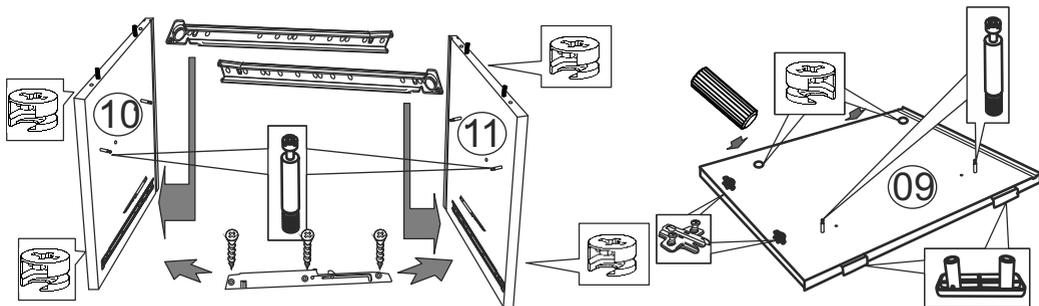
Стенку вертикальную 09 оборудовать роликовой направляющей, демпферами, эксцентриками, соединительными винтами и шкантами. В отверстия на нижней кромке установить ножки. **Аналогично**
