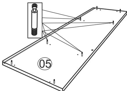
Стенки вертикальные 10 и 11 оборудовать роликовыми направляющими, демпферами, эксцентриками, соединительными винтами
