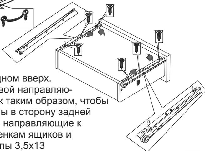
Установить ящик дном вверх. Ответные части роликовой направляющей установить на ящик таким образом, чтобы ролики были направлены в сторону задней стенки. Плотно прижать направляющие к передней и боковым стенкам ящиков и зафиксировать на шурупы 3,5x13
