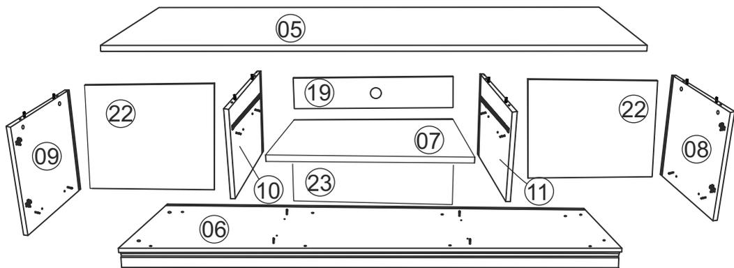
Собрать тумбу. Установить ящик и двери. На эксцентрики и евровинты установить заглушки. На двери и переднюю стенку ящика установить ручки. Отрегулировать двери, при необходимости установить под ножки пластиковые подставки. Закрепить задние стенки к каркасу на соединитель задней стенки с шурупом.
